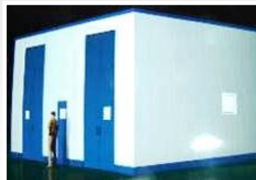
全封闭扶梯传感测试静音房
